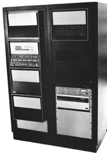
FIGURA 12 – Comutador de Pacotes TIP desenvolvido pela BBN
